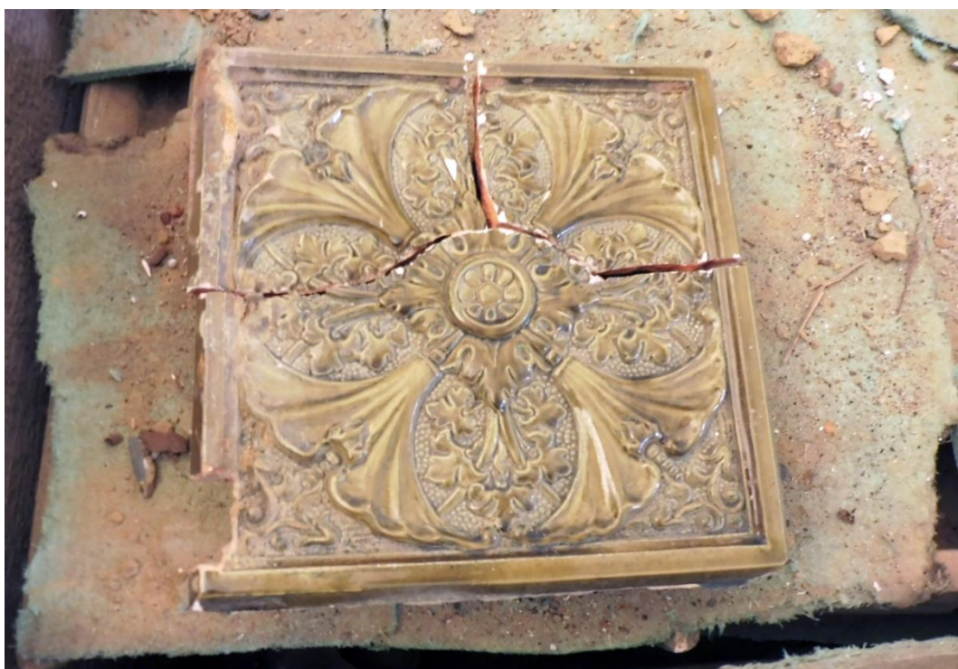
Fot. nr 3, 4– Kossakówka – Plac Kossaka 4, Kraków. Sposób pakowania kafli eklektycznych pieca nr 1 w skrzyni oraz na dolnym zdjęciu kafel popękany na skutek nadmiernego obciążenia płasko leżącymi kafłami górnych warstw. W dolnej krawędzi popękanego kafla widoczne wtórne, prostokątne wycięcie. fot. Andrzej Karbowski – styczeń 2021 r
