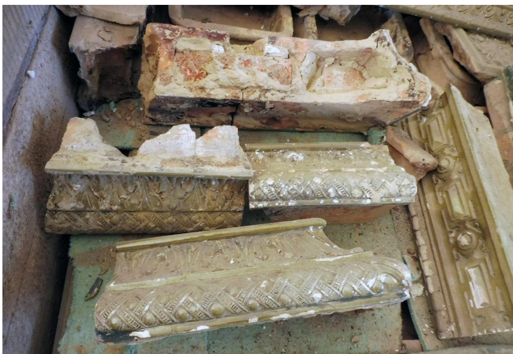
Fot. nr 1, 2 – Kossakówka – Plac Kossaka 4, Kraków. Skrzynia zawierająca kafle pieców nr 1 i 2. Żeliwne drzwiczki widoczne na wierzchu to kopia XIX-wiecznych drzwiczek ozdobionych głowami lwów. Pochodzi z przełomu XX/XXI wieku – można to rozpoznać po kształcie mosiężnych zaczepów do zamykania górnych i dolnych drzwiczek. Fragmenty gzymsu środkowego z uszkodzeniami mechanicznymi (obicia, pęknięcia) i chemicznymi – spudrowanie angoby i odpadanie szkliwa będące wynikiem przemrożenia kafli. Fot. Andrzej Karbowski – grudzień 2020r, marzec 2021 r.
